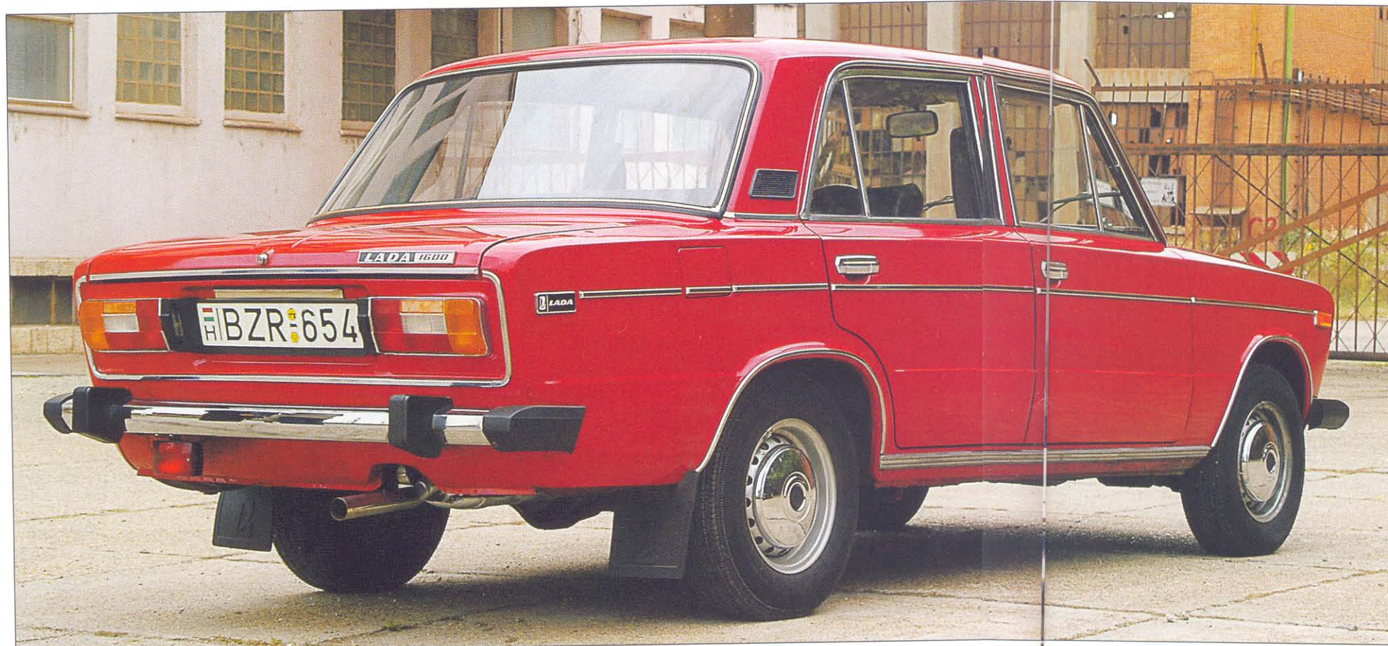
A kipufogótoldás az egyetlen idegen elem. A körlámpás Ladák közül egyedül a 2106-osnak voltak szögletes lökhárítóbaí
