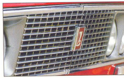
Sosem mosták le elég alaposan az autót: helyenként megvan még a gyári zsírréteg a hűtőrácson és alatta
